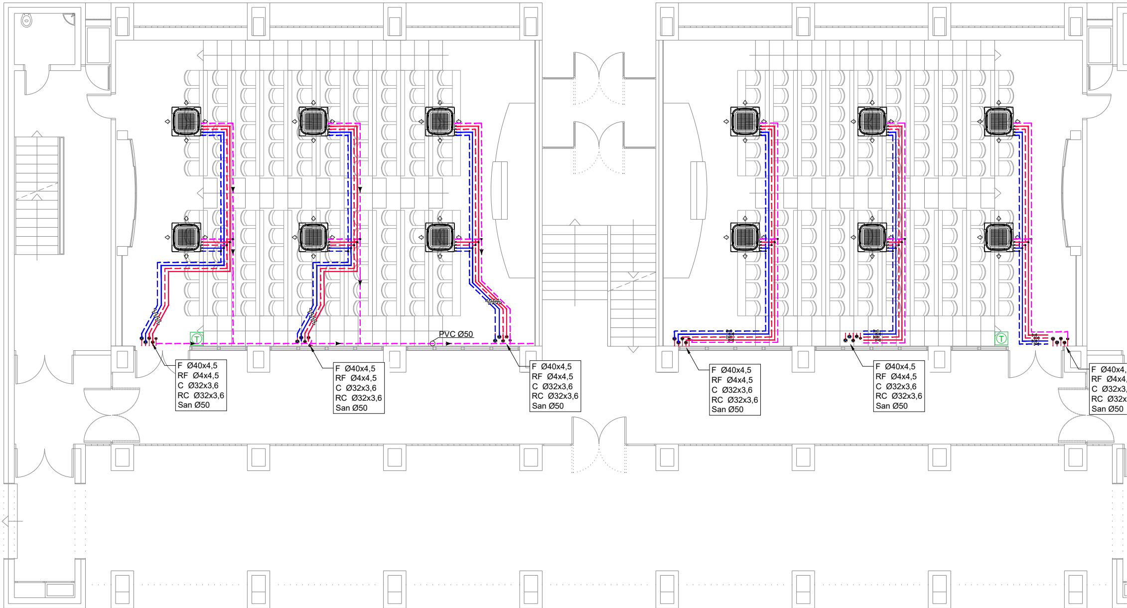
Colocación abrazaderas que NO permitan la dilatación "Abrazaderas Rias" (Tabla B.8 UNE-EN 806-4)
